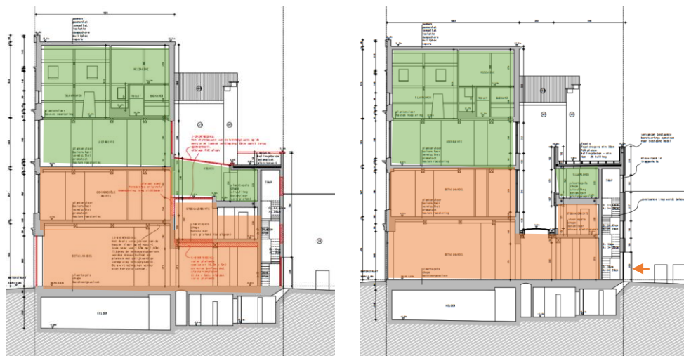
Langsdoorsnede : bestaande toestand en ontwerp, handel aangeduid in oranje en woning in het groen (plannen uit het aanvraagdossier met annotatie KCML)
